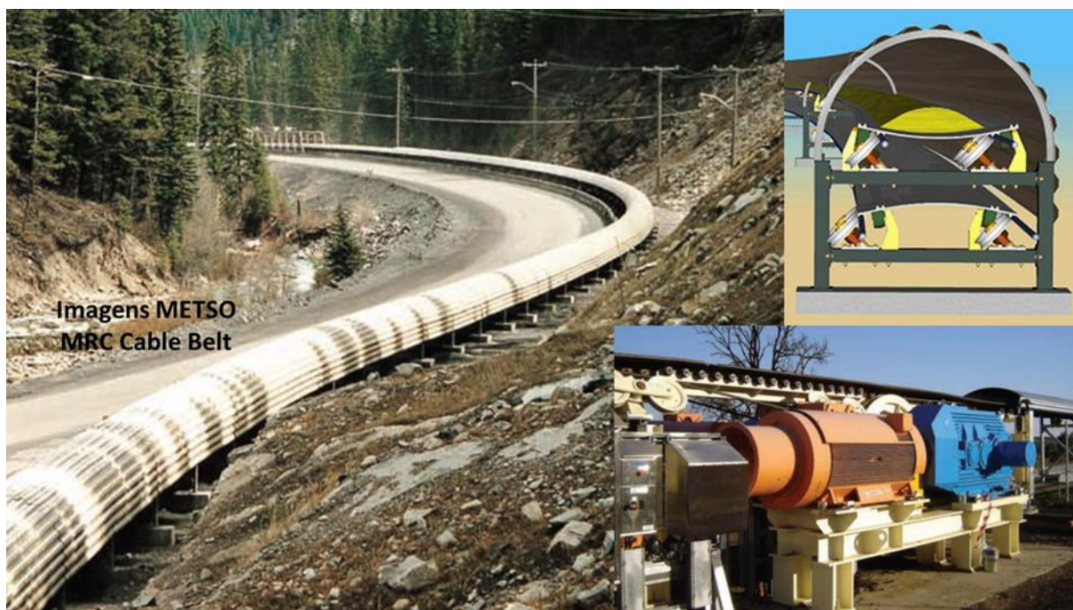
Figura 6 – Correia transportadora tipo “MRC Cable Belt” da Metso
